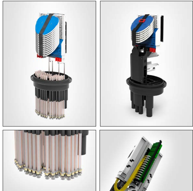
Oben links: FDN-IR Muffe (59 Ports, Länge AB) mit 12 SE-IR MKII Spleißkassetten und vorkonfektionierte Mikrorohr-Einführung.
