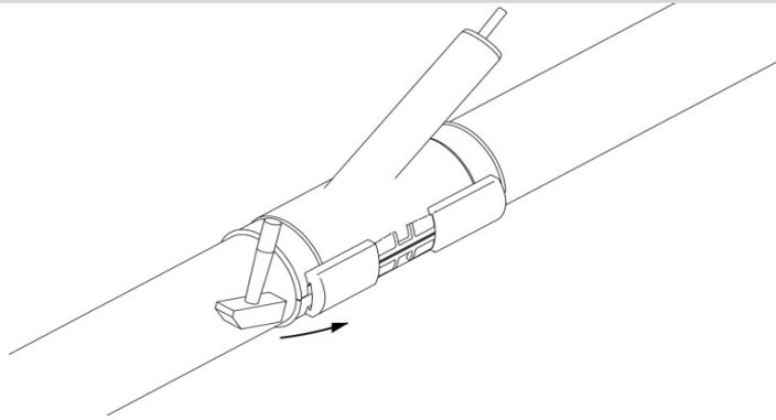
4) Die Verbindungsklammern von Hand montieren und anschließend mit dem Hammer gleichmäßig festtreiben.
